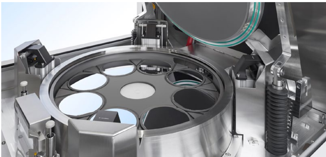
Unsere Anlage zur Laserproduktion AIX2800G4-TM in der Konfiguration 8x6 Zoll.
